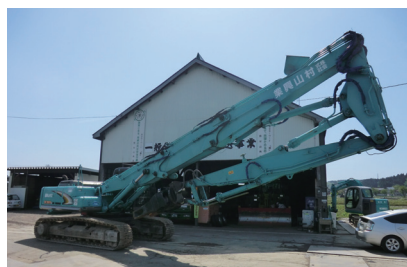
24m級のビル解体も可能な50tクラス1台に35tクラス2台をはじめ多数の解体重機を保有する
